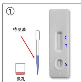
(2) 用移液器或滴管吸取 120 μL (约 4 滴) 待测液, 滴加到金标微孔中, 用滴管或移液器反复吸打以溶解微孔中的红色物质, 等待反应 2 分钟。
