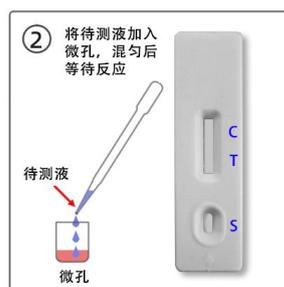
(3) 吸取微孔中全部液体垂直缓慢滴加到检测卡的加样孔 (S) 中; 液体流动时开始计时, 反应 8~10 分钟, 根据示意图判定结果, 其他时间判定无效。
