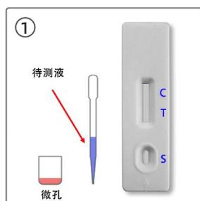
(2) 用移液器或滴管吸取 120  $\mu$ L (约 4 滴) 待检液，垂直滴加到金标微孔中，用滴管或移液器反复吸打以溶解微孔中的红色物质，等待反应 2 分钟。
