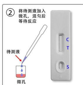
(3) 吸取微孔中全部液体垂直缓慢滴加到检测卡的加样孔(S)中；液体流动时开始计时，反应8~10分钟，根据示意图判定结果，其他时间判定无效。
